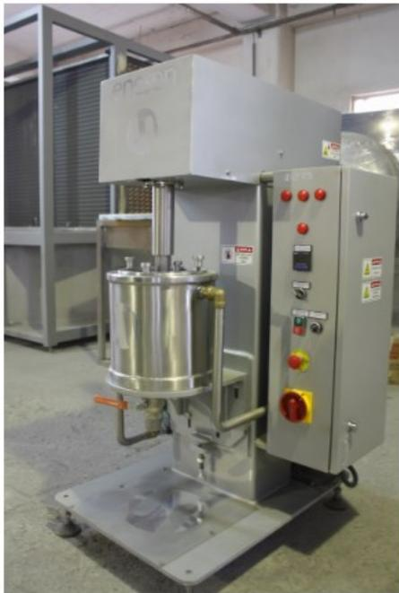
Шоколадное тесто разбавляют до нужного микрона, чтобы оно стало продуктом потребления. Шероховатое состояние шоколадного теста разжижается на этой машине до нужного микрона. Консистенция и толщина шоколада, который будет напечатан на шоколадной форме, очень важны. Поэтому для шаровой мельницы важны количество используемых шаров, диаметр, качество, качество нержавеющей стали, коэффициенты безопасности.
